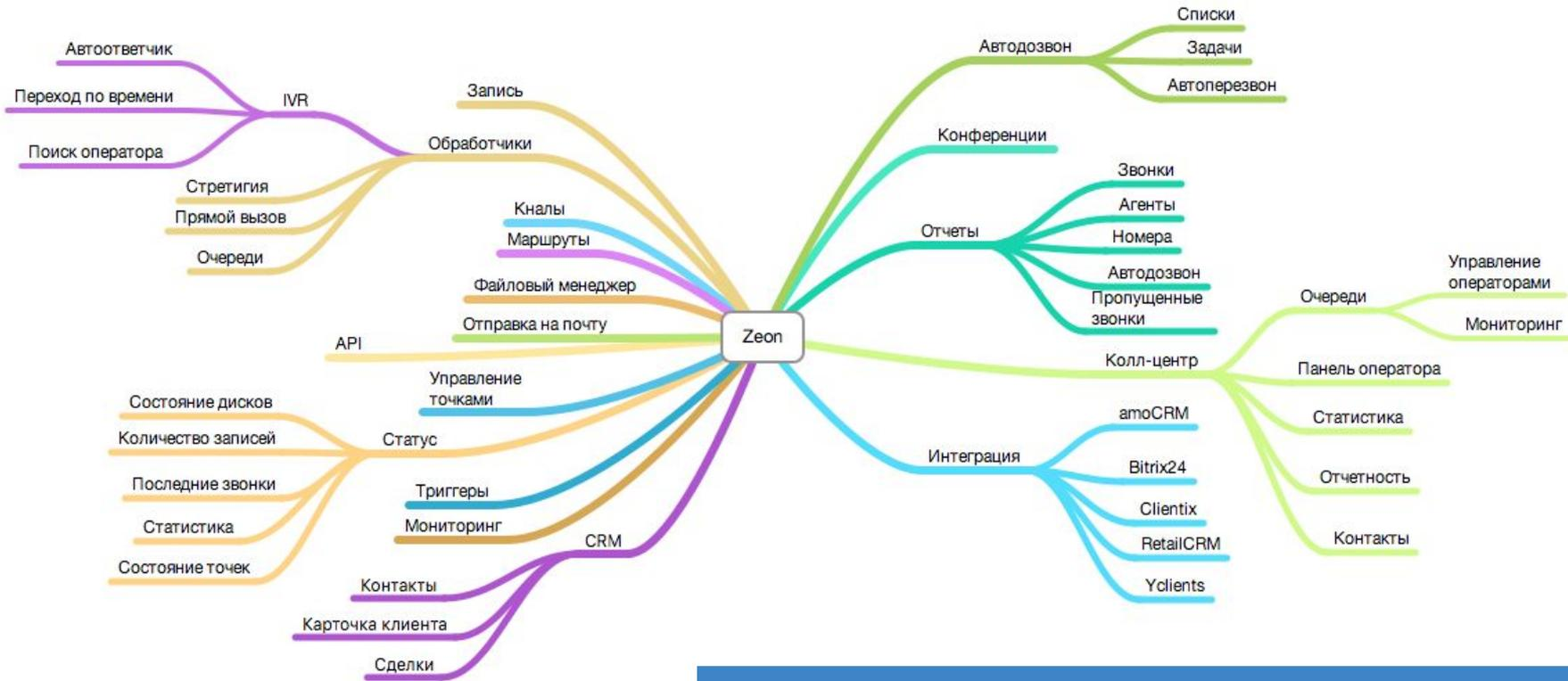
Функциональные возможности IP-ATC Zeon
